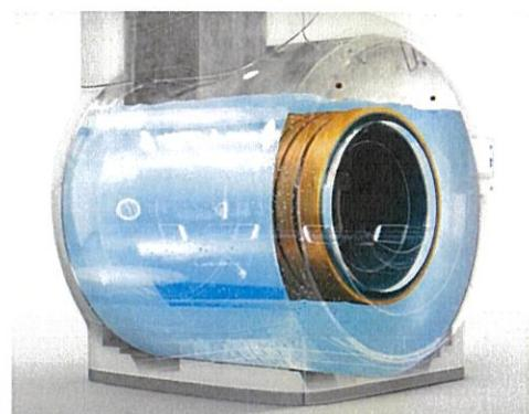
図1. MR装置構造
